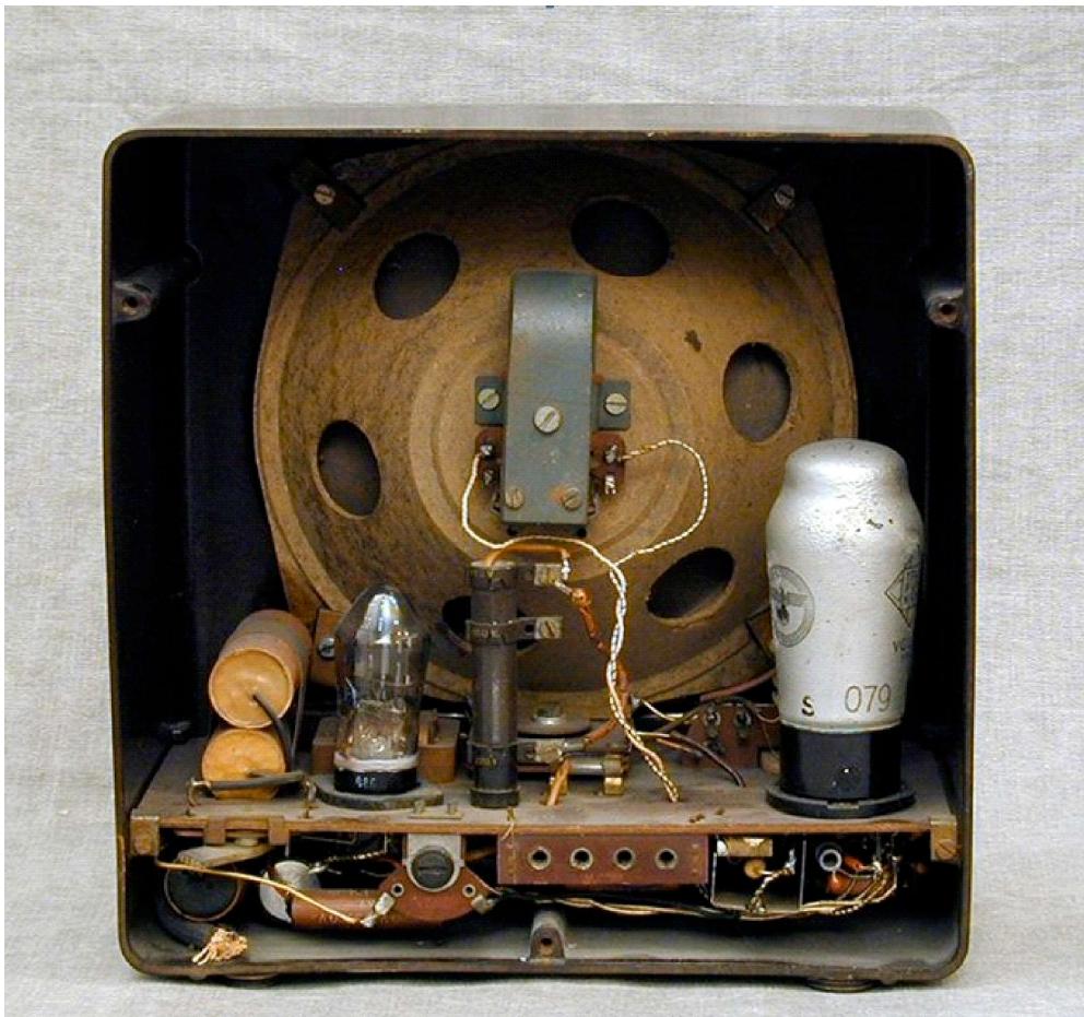
Figure 6 – Intérieur du poste DKE 38
