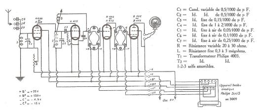
Dans beaucoup de cas le poste est tellement puissant que la self de réaction (3) peut être supprimée. La lampe HF A. 442 peut être blindée, cette précaution n'est pas absolument nécessaire.
